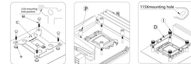
Ajuster la position de la plaque arrière. Placer la plaque arrière derrière la carte-mère, mettre en place les entretoises et les supports LGA115X/1200 puis fixer avec les vis.
