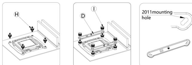
Mettre en place les vis LGA20XX, placer les supports Intel et fixer avec les écrous.
