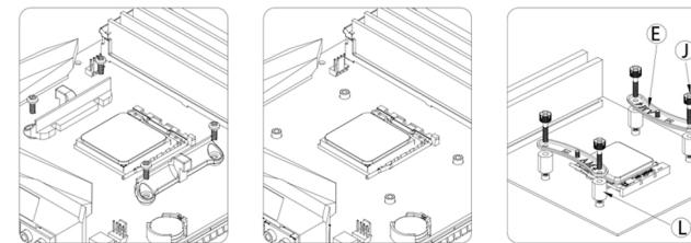
Retirer le support de fixation en plastique AMD AM4, garder la plaque arrière fixée, à l'aide des vis AM4 et entretoises installer les supports.
