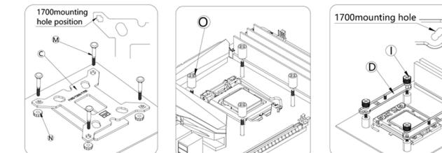
Ajuster la position de la plaque arrière. Placer la plaque arrière derrière la carte-mère, mettre en place les entretoises et les supports LGA1700 puis fixer avec les vis.
