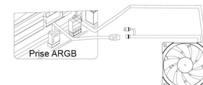
Pour les ventilateurs ARGB, pour contrôler les LED, connectez les prises 3 pins 5V au port prévu à cet effet sur la carte mère. Les LED ARGB peuvent être synchronisées en les reliant entre elles.
