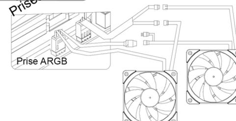
Pour les ventilateurs ARGB, pour contrôler les LED, connectez les prises 3Pins 5V à la prise sur la carte-mère prévu à cette effet ou à un contrôleur prévu. Les LED peuvent être synchronisés en branchant les ventilateurs entre eux.
