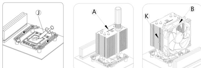
Appliquer une fine couche de pâte thermique, puis fixer le dissipateur ainsi que le ventilateur à l'aide des clips.
