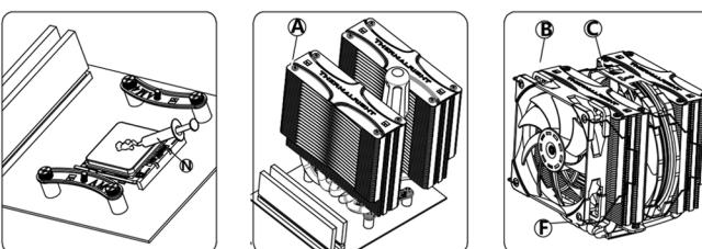
Appliquer une fine couche de pâte thermique, puis fixer le dissipateur ainsi que les ventilateurs.
