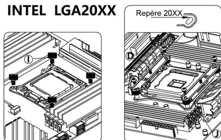
Placer les vis LGA20XX, mettre les supports dessus et visser avec les vis (J).
