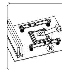
Appliquer une fine couche de pâte thermique, puis fixer le dissipateur ainsi que les ventilateurs.
