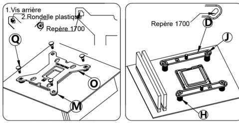
Placer la plaque arrière derrière la carte-mère sur le repère 1700 ainsi que les vis arrières avec les rondelles en plastique comme sur l'image. Mettre en place les entretoises et les supports Intel puis fixer avec les vis (J).
