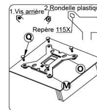
Placer la plaque arrière derrière la carte-mère sur le repère 115X ainsi que les vis arrières avec les rondelles en plastique comme sur l'image. Mettre en place les entretoises et les supports Intel puis fixer avec les vis (J).
