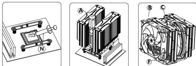
Appliquer une fine couche de pâte thermique, puis fixer le dissipateur ainsi que les ventilateurs.
