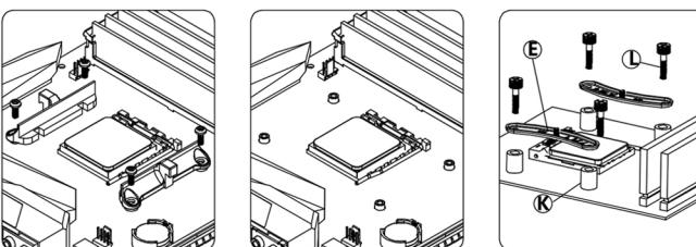
Retirer le support de fixation en plastique, garder la plaque arrière fixée à l'aide des vis AM4 ainsi que les supports AMD.
