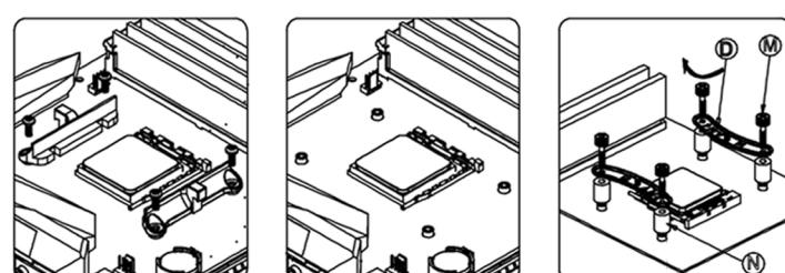
Retirer le support et vis d'origine, garder la plaque arrière. Installer 4 entretoises sur la plaque arrière et fixer les deux supports AM4 / AM5 avec 4 vis.
