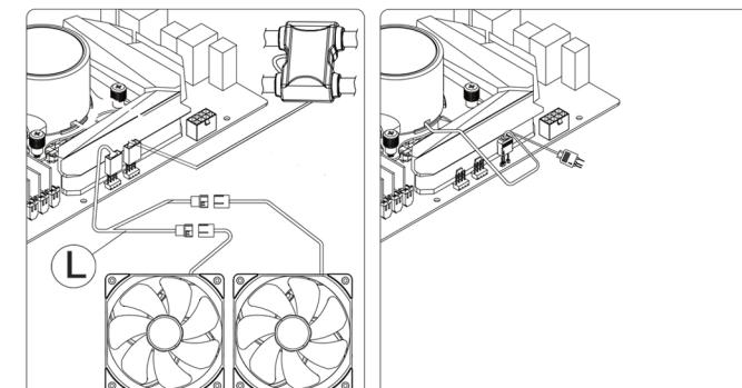
Utiliser les longues vis pour installer le(s) ventilateur(s) sur le radiateur
