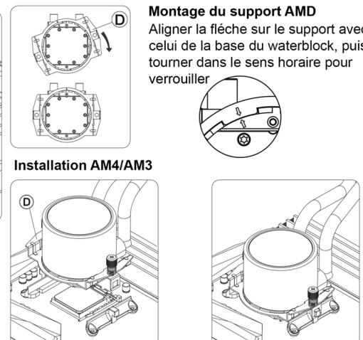
Appliquer une fine couche de pâte thermique, puis fixer le waterblock sur le support avec les 2 vis
