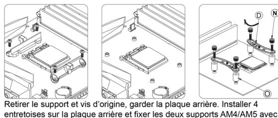
Retirer le support et vis d'origine, garder la plaque arrière. Installer 4 entretoises sur la plaque arrière et fixer les deux supports AM4/AM5 avec
