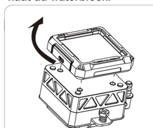
Le haut du waterblock est magnétique et peut être tourné dans les quatre directions.
