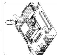
Appliquer une fine couche de pâte thermique, puis fixer le waterblock sur le support avec 2 écrous
