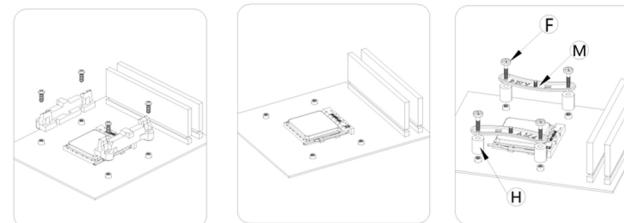
Retirer le support de fixation en plastique AMD AM4, garder la plaque arrière fixée, à l'aide des vis AMD et entretoises installer les supports.
