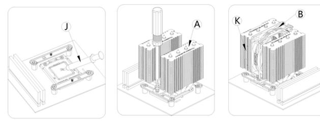
Appliquer une fine couche de pâte thermique, puis fixer le dissipateur ainsi que le ventilateur à l'aide des clips.
