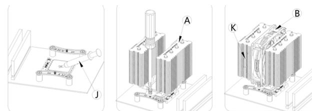
Appliquer une fine couche de pâte thermique, puis fixer le dissipateur ainsi que le ventilateur à l'aide des clips.
